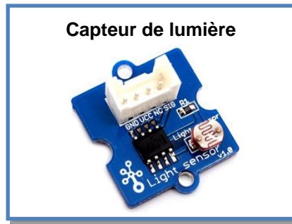
Informations d'entrée et de sortie du capteur de lumière
