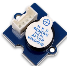
Buzzer Transforme l'énergie électrique en son
