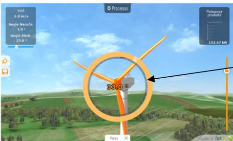
Il permet d'ajuster la portance des pales à la vitesse du vent pour maintenir une puissance sensiblement constante.
