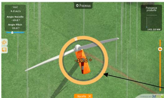
L'orientation est généralement assurée par des moteurs électriques, par l'intermédiaire d'une couronne dentée. Cette éolienne comporte un système de blocage mécanique de la position de la nacelle suivant une orientation donnée : cela évite de solliciter constamment les moteurs et permet aussi de bloquer l'éolienne durant les opérations de maintenance.
